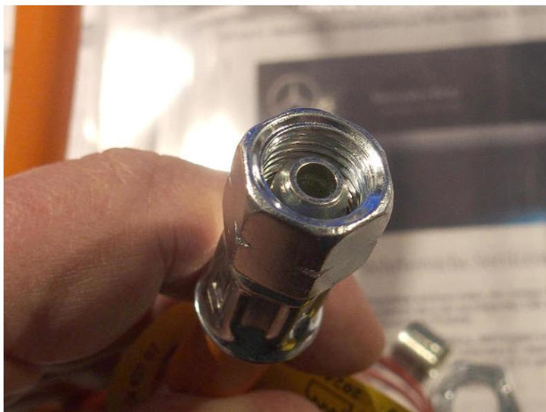
In questa ultima foto si vede invece il raccordo con attacco standard per regolatori filettati, con filetto rovescio e innesto conico di tenuta e qui ci si avvita il regolatore GOK.
