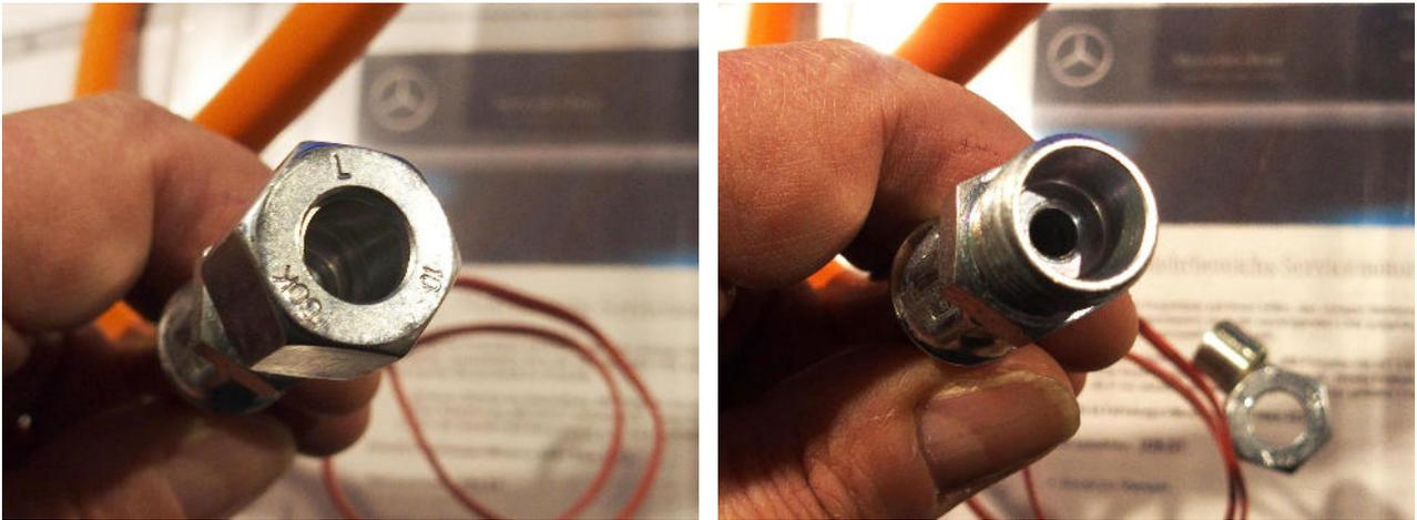
Questo è il raccordo per il tubo metallico da Ø 10mm, a sinistra completo, a destra dopo avere svitato la ghiera e tolto l'oliva perché si usano quelle già presenti sul tubo metallico del camper. Rimane un attacco identico a quello presente sul Duocontrol CS. Questo raccordo va infatti avvitato al posto del Duocontrol CS dopo averlo rimosso.
