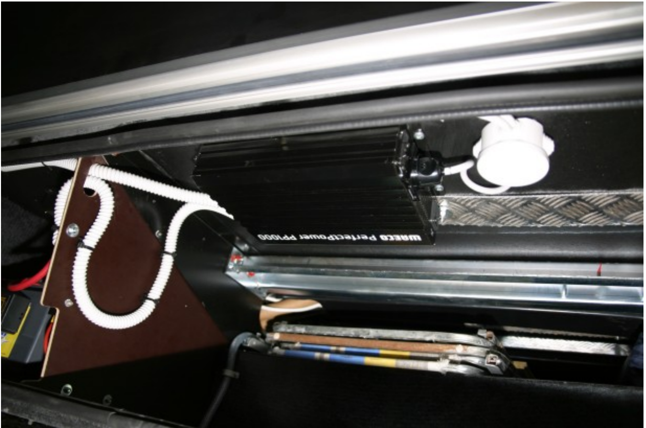
l' inverter sul soffitto del gavone, la scatola di derivazione 220v, le guaine per cavi 12v.
