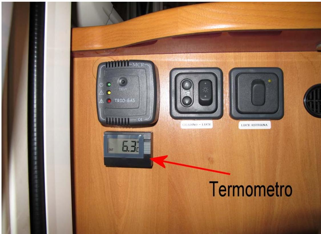
all'interno della cellula ho fissato un termometro che misura la temperatura nel vano dell'EFOY tramite una sonda con filo.
