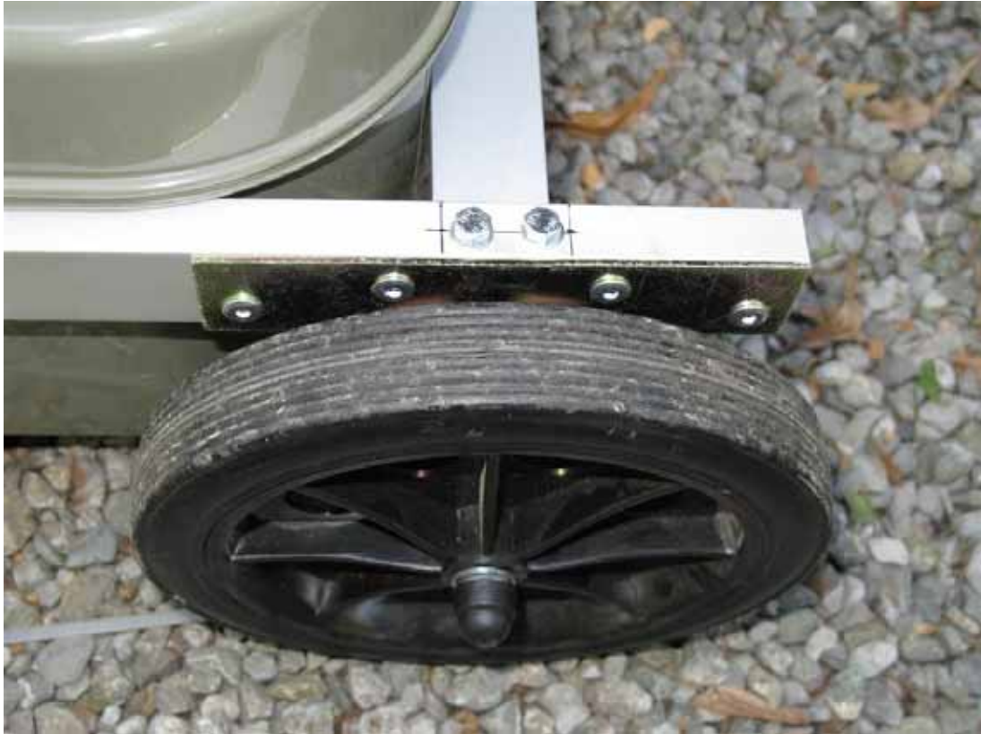
FOTO 7 : particolare del fissaggio di asse e ruote
