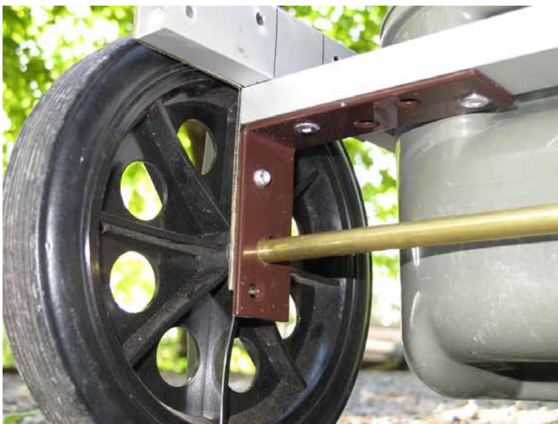
FOTO 6 : particolare del fissaggio di asse e ruote
